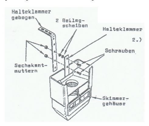
2. Um den Skimmer am Becken zu befestigen wird die Halteklammer sorgfältig über das Verbindungsstück gebogen, oben ein Loch gebohrt und mit der Befestigungsschraube fest angeschraubt
