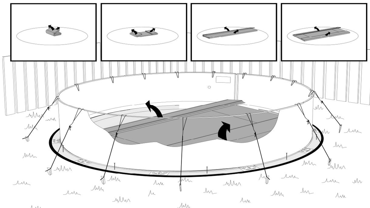
Die senkrechte Schweißnaht der Folie dient als Ausgangspunkt. Beachten Sie, dass diese nicht im Bereich des Skimmers oder der Einströmdüse ist.
