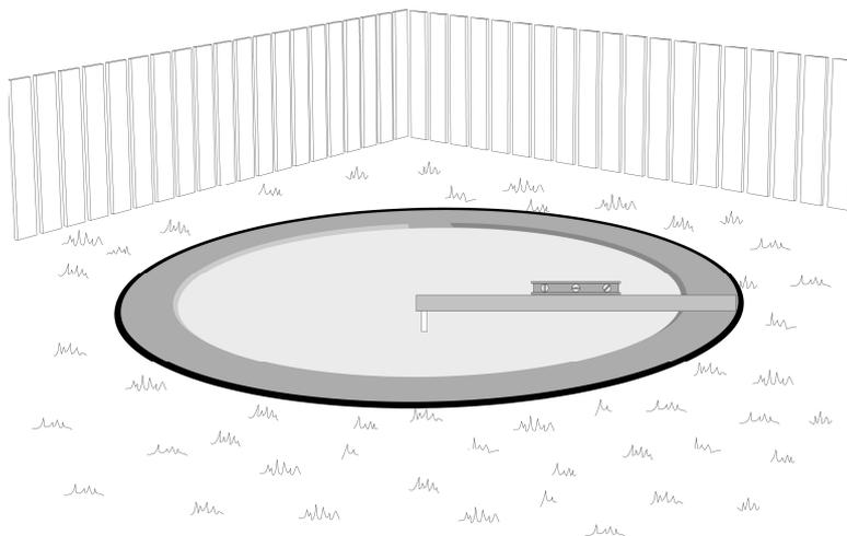
Statt dieses Sandplatzes können Sie den Untergrund Ihres Beckens auch mit Styropor-Hakenfalzplatten oder XPS-Platten bilden. In diesem Fall wird auf der freigelegten Fläche eine 2 – 3cm starke Schicht mit feinem Splitt (Körnungsgröße 3-4mm) aufgebracht, verdichtet und wasserwaageeben abgezogen. Darauf werden die Styroporplatten aufgelegt und unverrückbar miteinander verbunden.
