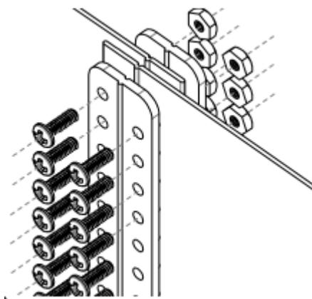
Decken Sie die Innenliegenden Schraubenköpfe vollständig mit Gewebekband ab damit es später zu keinen Schäden an der Innenfolie kommt.
