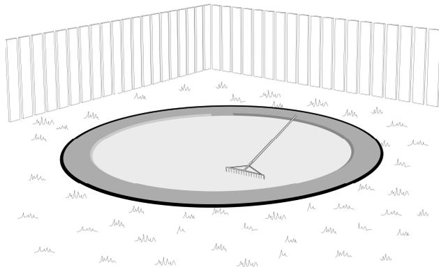
Da der hier entstehende Platz nicht glatt bzw. wasserwaageeben ist, muss dies mit reinem Sand ausgeglichen werden.
