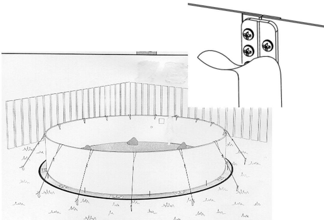
Anschließend muss auf der Poolinnenseite eine gleichmäßige Hohlkehle zwischen Boden und Stahlwand (ca. 15 cm) aus feinem Sand gemacht werden. Den Sand zum Verdichten anfeuchten, anschließend mit einer Kelle glattstreichen.
