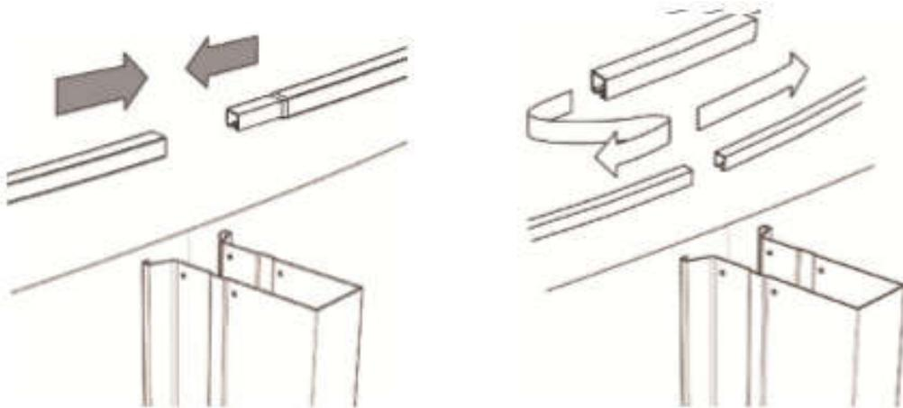
Mit der Steherkappe verbinden Sie nun Stahlwand und Steher. Schieben Sie die Kappe über Auflageschienen und Steher und schrauben Sie sie mit den Sechskantschrauben am Steher fest. Üben Sie während des Schraubens etwas Druck auf den hinteren Teil der Steherkappe aus damit die Schrauben die Kappe gut niederhalten.
