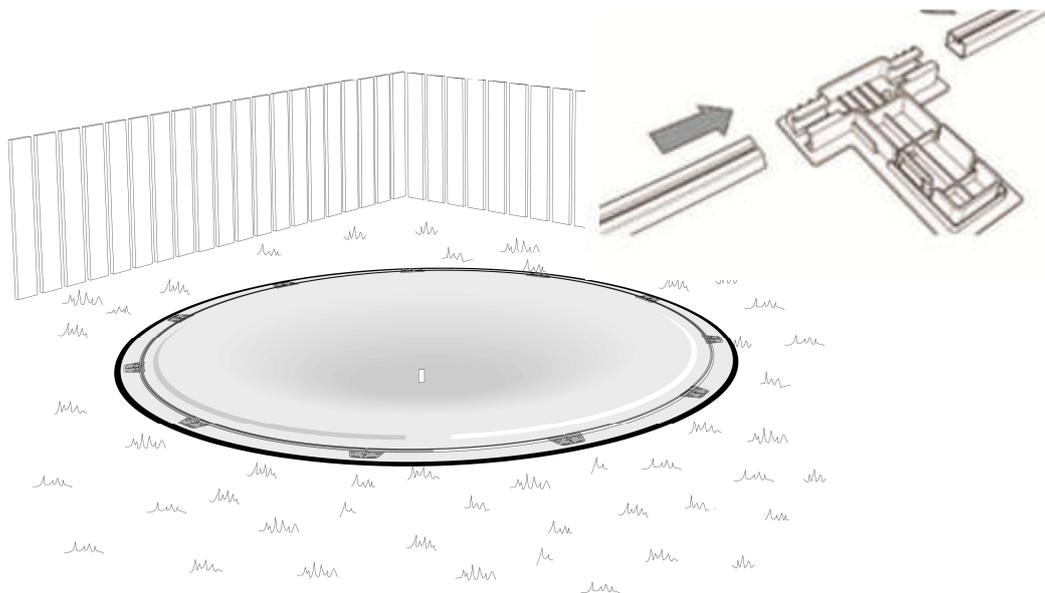
Wenn Sie die Bodenschienen fertig aufgelegt und verbunden haben, messen Sie den Durchmesser des erhaltenen Kreises an mehreren Stellen. Der Durchmesser muss überall derselbe sein. Sollte das nicht der Fall sein passen Sie die Lage der Schienen so lange an bis Sie wirklich einen Kreis erhalten. Eine leicht ovale Form kann in späterer Folge zu Problemen führen.
