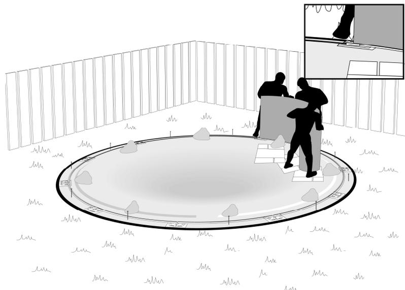
Ebenso empfehlen wir, die Stahlwand mittels Haken und Schnur zusätzlich zu fixieren, damit diese nicht einstürzen kann.
