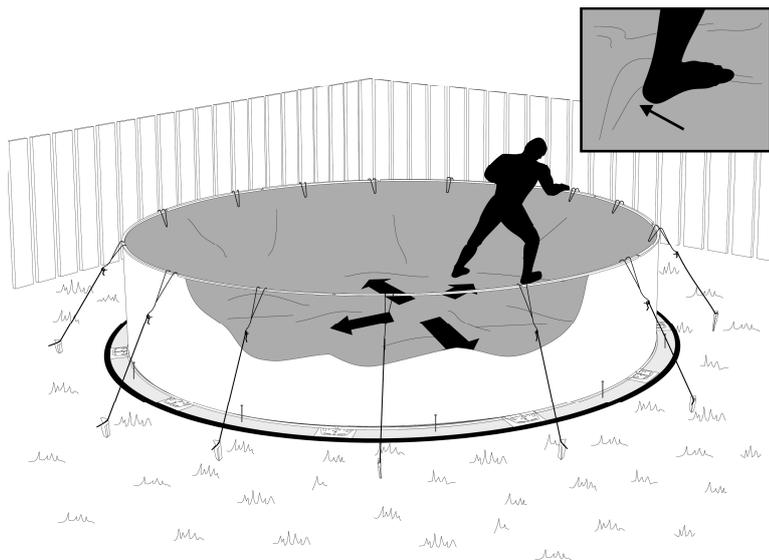
Wenn der Boden fertig geglättet ist, wird die Folie über die Stahlwand nachgespannt und rundherum mit dem Poolcoping fixiert.
