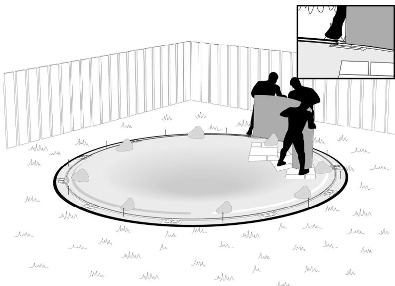
Ebenso empfehlen wir, die Stahlwand mittels Haken und Schnur zusätzlich zu fixieren, damit diese nicht einstürzen kann.
