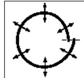
Die Enden der Poolwand werden verbunden, indem Sie für jedes Loch jeweils eine Schraube und eine Mutter verwenden, wobei der Schraubenkopf jeweils auf der **Innenseite** des Pools und die Mutter auf der **Außenseite** der Poolwand liegen müssen. Alle Schrauben und Muttern fest anziehen! Die Fuge und die Schraubenköpfe auf der Innenseite der Poolwand sind ganz mit 50 mm breitem Klebeband zu überkleben.
