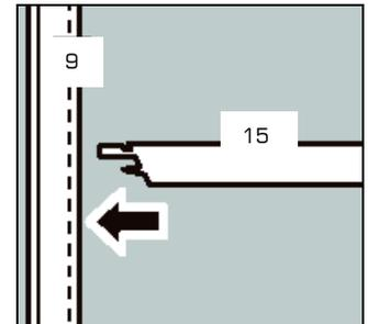
Die Schrägstütze am eingeschobenen Ende hochziehen, so dass die Nasen in die Schlitzte einrasten. Gleichzeitig das andere Ende der Schrägstütze nach unten auf die Befestigungslasche (**Teile-Nr. 16**) auf dem Zugband drücken.
