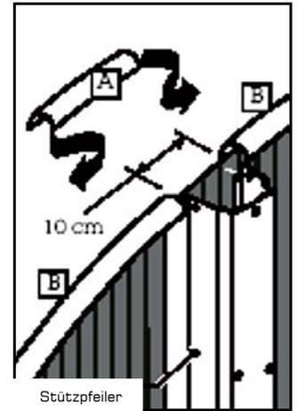
Die Stahlmantelversteifungsschienen sind farbcodiert oder mit einer Teilenummer versehen. Bitte benutzen Sie die untenstehende Tabelle, um die Art und Stückzahl der Versteifungsschienen für Ihr Pool auszuwählen (Teilenummern werden unter jeder Farbe in Klammern angegeben).
