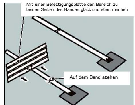
Heben Sie das Zugband vorsichtig hoch und stecken Sie vier 3/4 Zoll lange Schrauben (**Teile-Nr. 21**) in die Löcher, die am nächsten zur Mitte des Pools liegen. Gehen Sie sicher, dass die Schraubenköpfe dem Boden zugekehrt sind. Das Band zurück auf den Boden legen und die Druckplatte (**Teile-Nr. 11**) und Stehergrundplatte (**Teile-Nr. 23**) über die aus dem Zugband hervorragenden Schrauben stecken, die Muttern auf den Schrauben befestigen und festziehen.
