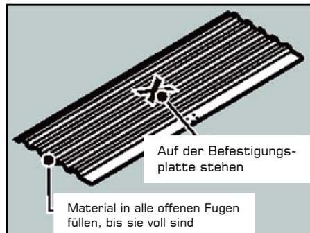
Nachdem die Ränder der Druckplatten mit Material gefüllt sind, legen Sie eine Plastikfolie auf jede Seite der Druckplatten, um weitere Materialbewegungen zu verhindern, die später nach Wasserfüllung zu unebenen Stellen führen könnten.
