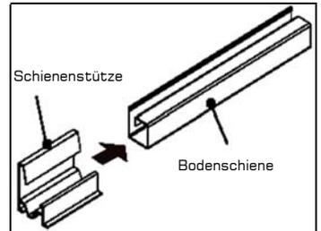
Montieren Sie die **Steherbodenschienen** zwischen die Steher (Wenn Sie ein 5,50 x 3,60m Pool haben, überspringen Sie diesen Schritt und gehen gleich zu dem nächsten Schritt ). Die Bodenschienen werden in die Kerbe des Stehers geschoben. Stellen Sie sicher, dass die Rille der Bodenschienen immer nach oben zeigt.
