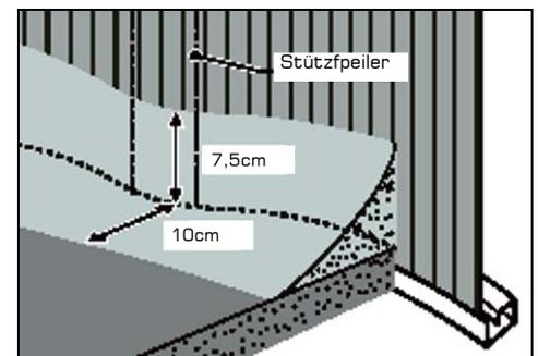
Zusätzlich empfehlen wir, den Beckenboden mit einer Vliestrennlage faltenfrei auszulegen. Wenn Sie den Beckenboden mit Styroporplatten auslegen, **muss** eine Trennlage zwischen Styropor und der Schwimmbadfolie zu liegen kommen.
