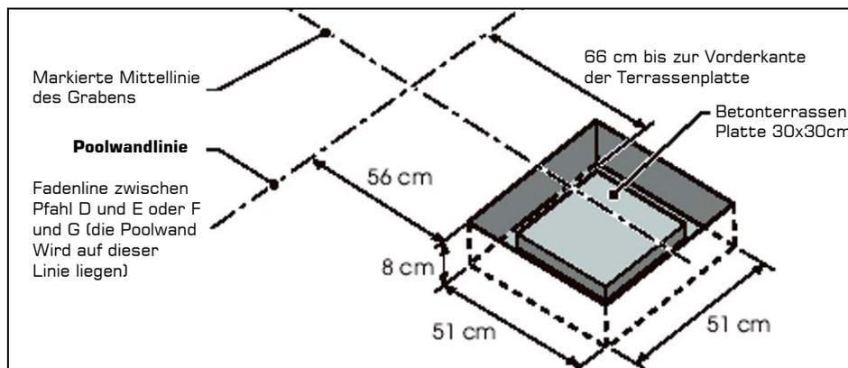
Spannen Sie wieder vorübergehend die Schnüre, um zu überprüfen, ob die Löcher **genau parallel** sind. Wenn Sie fertig sind, die Bindfäden wieder entfernen. Eine 25 mm dicke Schicht Kalksteinsplitt (oder einem entsprechenden Material) auf dem Boden der Plattengräben ausbreiten. Feststampfen.
