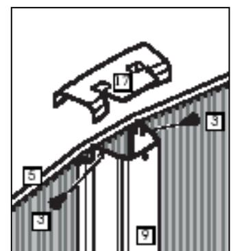
Montieren Sie die anderen Handlauf-Auflageplatten an den Stehern mit Schrägstütze. Montieren Sie nun die Handlaufschienen zwischen den Stehern an der geraden Stütze. Beachten Sie die oben stehende Tabelle bei der Schienenauswahl.
