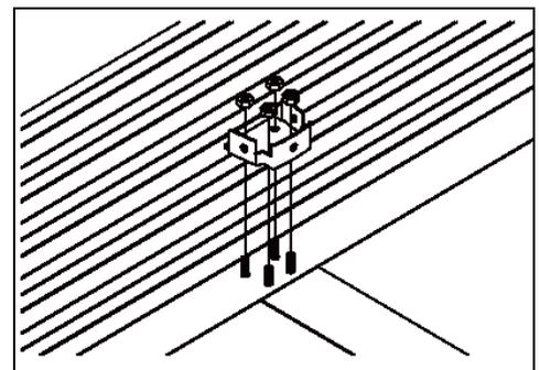
Befestigen Sie einen Steher (**Teile-Nr. 9**) mit 3/4 Zoll langen Schrauben (**Teile-Nr. 21**) und Muttern (**Teile-Nr. 10**) an der Stehergrundplatte. Prüfen Sie, ob das untere Ende des Stehers an der Grundplatte befestigt ist. Das untere Ende der Stehers hat drei große Löcher, die zur Befestigung an der Stehergrundplatte dienen.
