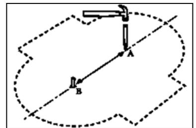
Befestigen Sie eine Schnur an Pflöck (A) und an einer Dose mit Sprayfarbe, und sprühen Sie eine Kreislinie auf den Boden. Dasselbe für Pflöck (B) wiederholen. Die Länge der Schnur, die Sie für Ihr Pool benötigen, entspricht dem Maß S in der oben stehenden Maßtabelle. Die Kreise sind überall 30 cm größer als das Pool selbst.
