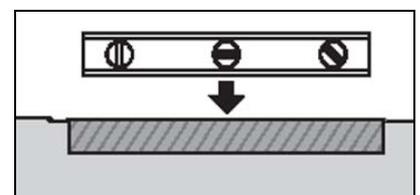
Prüfen Sie jede eingebaute gebogene Bodenschiene mit der Wasserwaage, um sicherzustellen, dass sie horizontal ist.
