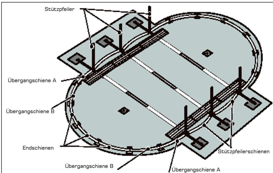
Das Pool mit der Größe 7,30 x 3,60m wird mit Schienenstützen (Teile-Nr. 20) aus Kunststoff geliefert. Wenn Sie ein 5,50m x 3,60m Pool besitzen, gehen Sie bitte zu dem Punkt, bei dem die Übergangsschiene A montiert wird, über. Bei allen anderen Pools die Schienenstütze, wie in Abbildungen, auf die Mitte der Steherbodenschiene schieben. Diesen Schritt für alle weiteren Steherbodenschienen wiederholen.
