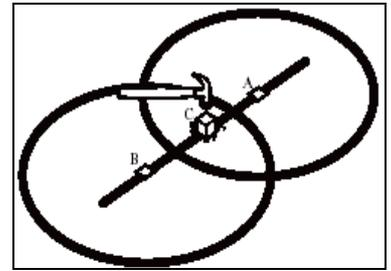
Die Pflöcke (A) und (B) durch zwei weitere flachköpfige Pfähle ersetzen. Soweit einhämmern, dass sie mit dem Boden abschließen. Die beiden Kreise mit zwei geraden Linien verbinden, um ein Oval zu erhalten. Die Linie mit der Spraydose auf den Boden sprühen. Als Anhaltspunkt jeweils eine Schnur zwischen zwei Pflöcken spannen.
