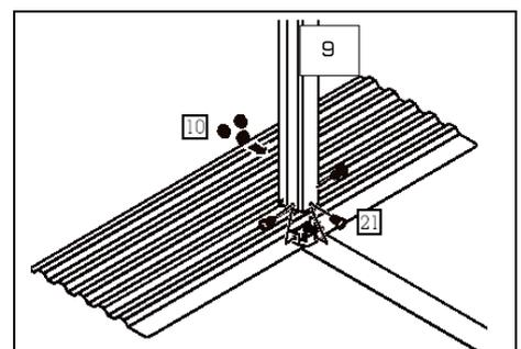
Prüfen Sie an dieser Stelle, ob sich an jedem Steher unterhalb der Nase am unteren Ende ein ca. 2 mm großer Spalt befindet, wo sich die Bodenschienen leicht einschieben lassen.
