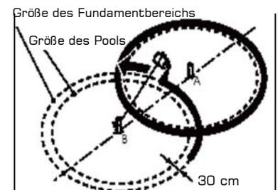
Verbinden Sie die beiden Pflöcke (A) und (B) mit einem Stück Schnur. Benutzen Sie die gespannte Schnur als Anhaltspunkt, um mit der Spraydose die Mittellinie auf den Boden zu sprühen.
