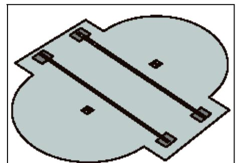
Zwischen dem Ende des Bands und der Außenkante der Waschbetonplatte sollte 6 cm Abstand bestehen.
