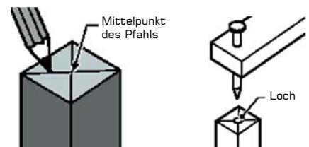
Benutzen Sie einen Nagel, der lang genug ist, um das Ende des Staffelholzes am Pflock zu halten, während Sie es rotieren. Legen Sie eine Wasserwaage auf das Staffelholz und bewegen Sie beides im Kreis, um die unebenen Stellen zu finden.
