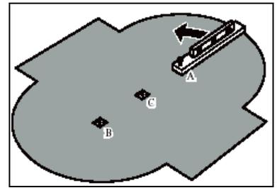
Alle hohen Stellen mit einer Schaufel, Hacke oder Harke entfernen. Wenn Sie eine große Fläche ebenen müssen, müssen Sie unter Umständen eine Erdbewegungsmaschine mieten. Nicht vergessen, Ihr Pool **muss** über den ganzen Durchmesser des Pools eben sein, bis auf 25 mm genau. Gegebenenfalls die Pfahlhöhe verstellen und Erde abtragen, bis der gesamte Bereich eben ist.
