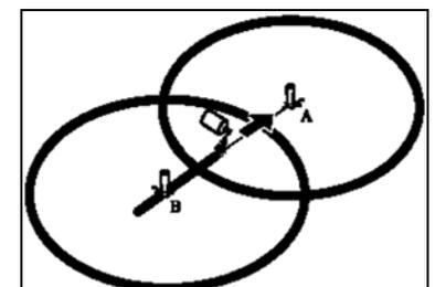
Einen flachköpfigen Pflock (C) genau auf halber Strecke zwischen Pflock (A) und (B) auf der Mittellinie in den Boden hämmern. Pflock (C) ist der exakte Mittelpunkt Ihres Pools. Messen Sie ihn sorgfältig ein; er wird Ausgangspunkt für weitere Maße sein. Der Pflock muss mindestens 25 mm im Quadrat und 15 cm lang sein. Soweit einhämmern, dass er mit dem Boden abschließt.
