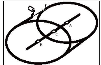
Die Bereiche entlang beider geraden Seiten Ihres Ovals markieren. Benutzen Sie Schnur und Pflöcke als Anhaltspunkt, um gerade Linien mit der Spraydose zu sprühen. Bitte die richtige Breite W von der Mittellinie des Pools aus der oben stehenden Tabelle entnehmen. Die Endpunkte der beiden Seitenbereiche sollten ein Quadrat mit Pfahl (A) und (B) bilden.
