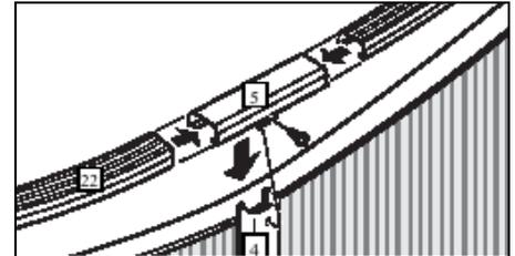
In gleicher Weise setzen Sie die Arbeit in der Poolrundung mit den 6 Stück normalen Endschienen fort. Wenn alle Handlaufschienen montiert sind, prüfen Sie nochmals, ob alle Steher senkrecht ausgerichtet sind. Verwenden Sie dazu eine Wasserwaage. Zum Schluss ziehen Sie alle Schraubverbindungen endgültig fest.
