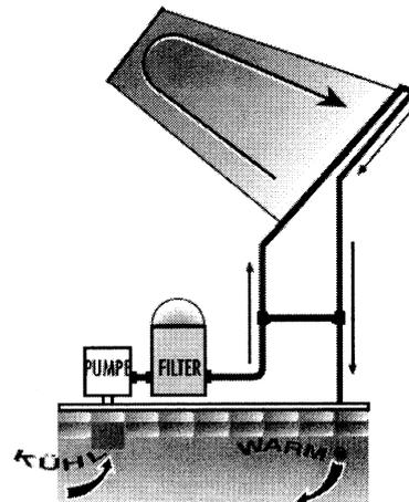
Schließen Sie das SUNHEATER-Umschaltventil zwischen Filteranlage, Solarsystem und Rücklaufleitung an, wie im unten stehenden Bild gezeigt.
