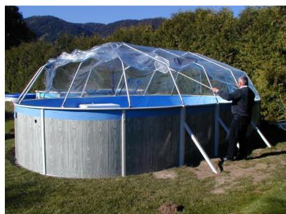
Die Schweißnähte der Sonnendomfolie sind versetzt zum Sonnendom-Gestänge angeordnet.
