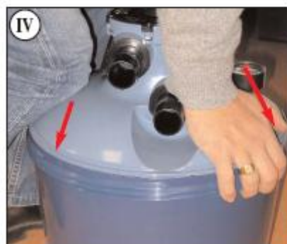
IV Drücken Sie den Deckel mit beiden Händen gleichzeitig auf den Tank. Der Druck auf dem Deckel muss aufrechterhalten werden, bis der Dichtring fest anliegt.
