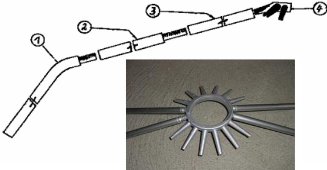
Dieser gesamte zusammengesteckte Teil (Sonnendomstern und 4 zusammengebaute Stangen) wird nun von 2 Personen, die jeweils 2 Stangen halten, über das Becken gehoben und in die entsprechenden Sonnendom-Füße gesteckt.
