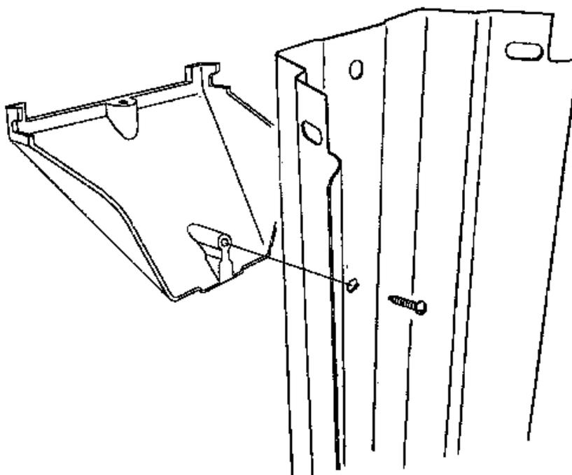
Jetzt stecken Sie jeden Steher in das Bodenschieneverbindungsstück bzw. Handlaufauflageplatte und verschrauben diese.
