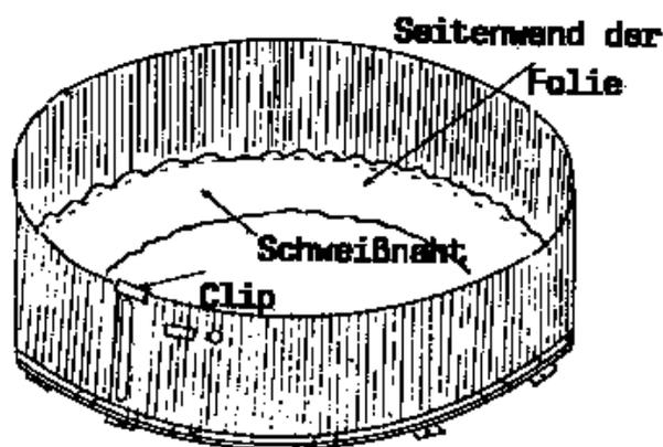
Jetzt muß bereits Wasser ins Becken eingelassen werden. Bei ca. 5 cm Wasserstand muß der Boden von innen nach außen mittels Füßen oder Händen geglättet werden.
