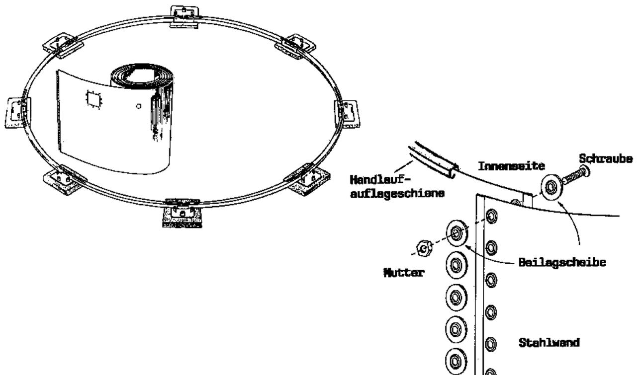
Stecken Sie den beige packten Metallclip über die Stoßstelle der Stahlwandenden.
