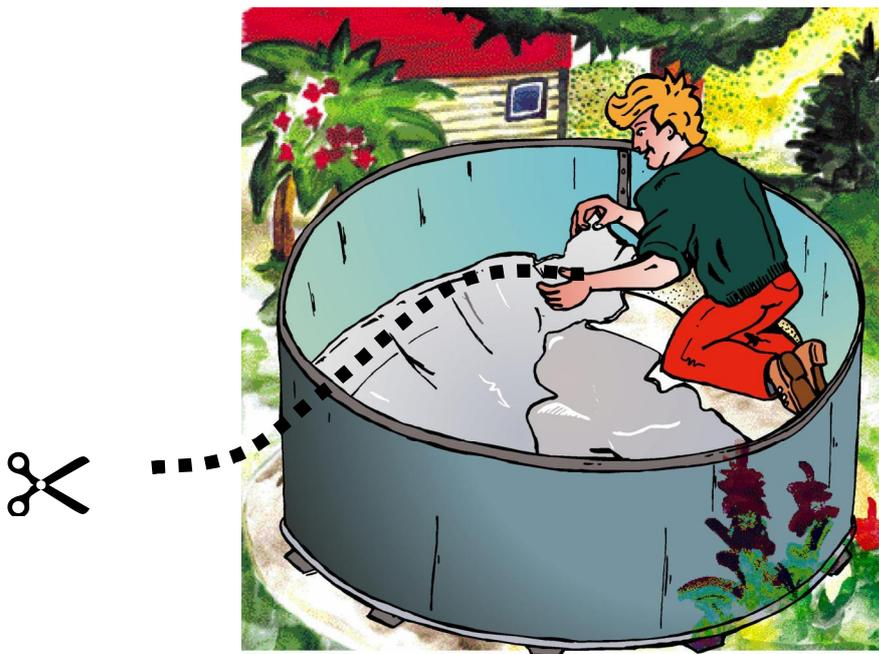
Das Vlies dient zum Schutz der Folie. Legen Sie das Vlies nach der Stahlmantelmontage und nach dem Anbringen der Hohlkehle (Erdkeil) auf dem Beckenboden auf und schneiden es dementsprechend mit einer gewöhnlichen Haushaltsschere zu. Kleben Sie die Enden im Abstand von ca 90cm mit einem Klebeband an die Stahlwand. Achten Sie darauf, dass das Vlies nicht zu sehr auf Spannung fixiert wird! Bei den runden Größen ab 4,50 bis 5,50 muss der Längsverschnitt in der Rundung angestückelt werden!
